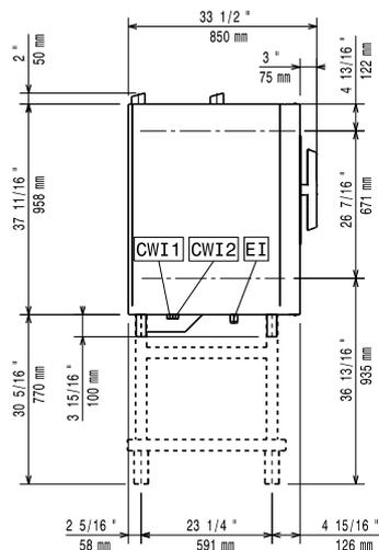
CWI1 = Raccordement eau froide      EI = Connexion électrique
